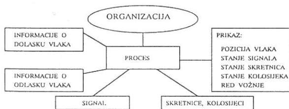
Slika 3. Pojednostavnjeni model upravljanja prometom kroz željezničku postaju
